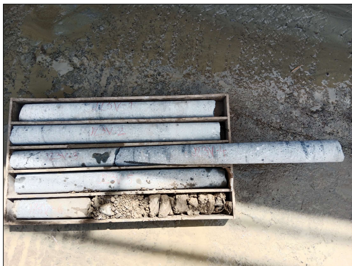
Obr. 23V Výnos jádra z téměř vodorovného vrtu J23V (+10° od vodor.) do levobřežní zdi spadiště v jádrovnici
