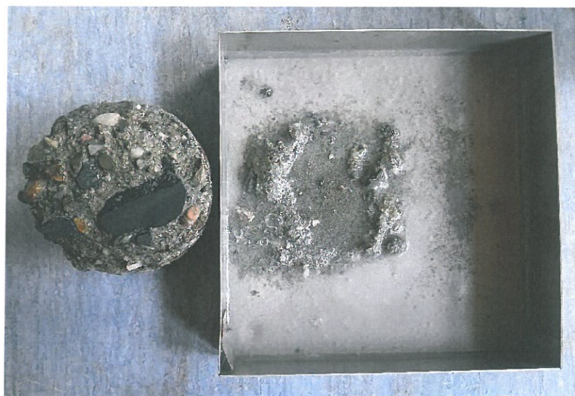
Obr. 16 Zkušební těleso J23V-1-B po 75 zatěžovacích cyklech včetně odpadlých částic v misce – jediné těleso „B“, které vykázalo vysoký odpad před dosažením 100 cyklů
