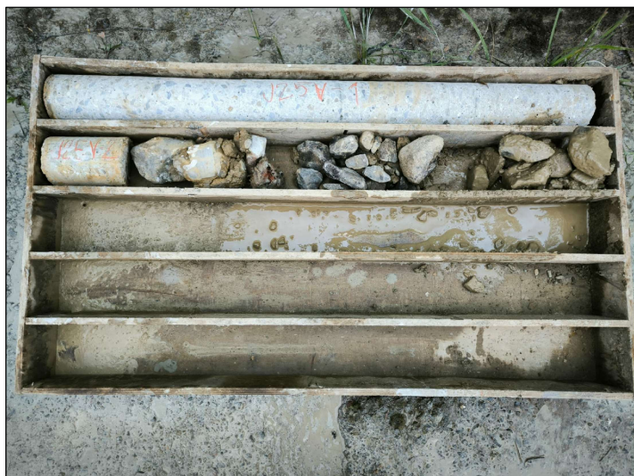
Obr. 25V Výnos jádra z téměř vodorovného vrtu J24V (–10° od vodor.) do levobřežní zdi skluzu v jádrovnici
