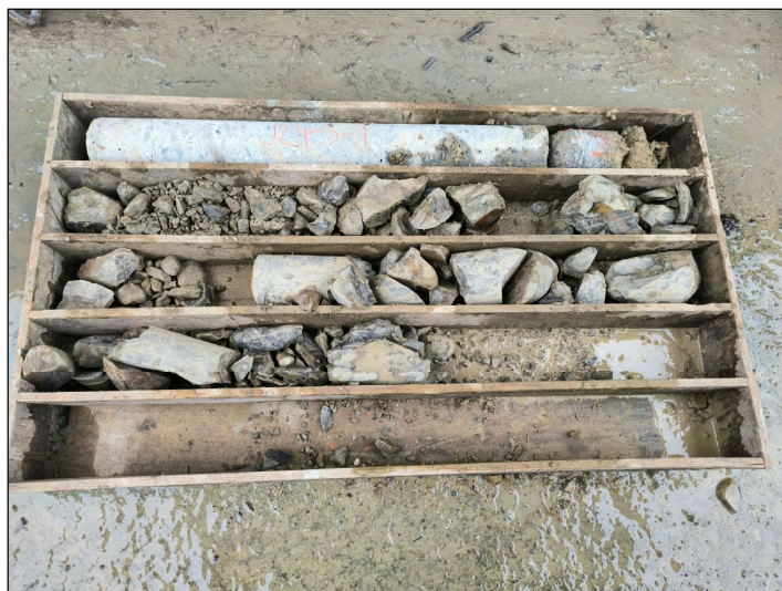
Obr. 24S Výnos jádra ze svislého vrtu J24S do dna spadiště v jádrovnici
