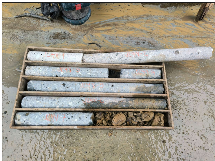
Obr. 24V Výnos jádra z téměř vodorovného vrtu J24V (+10° od vodor.) do levoběžné zdi spadiště v jádrovnici
