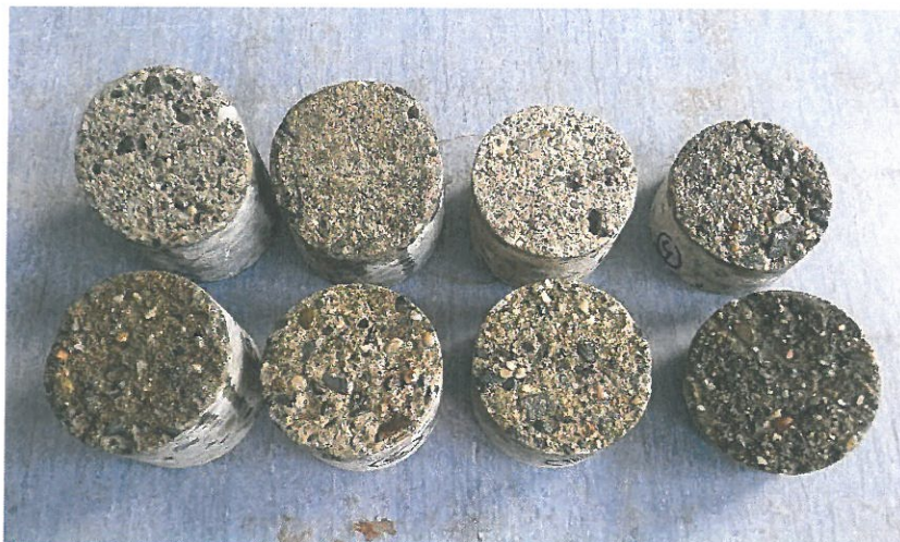
Obr. 7 Povrch betonu zkušebních těles „A“ byl očištěn ocelovým kartáčem, aby byla odstraněna případná vrstva mechu apod.
