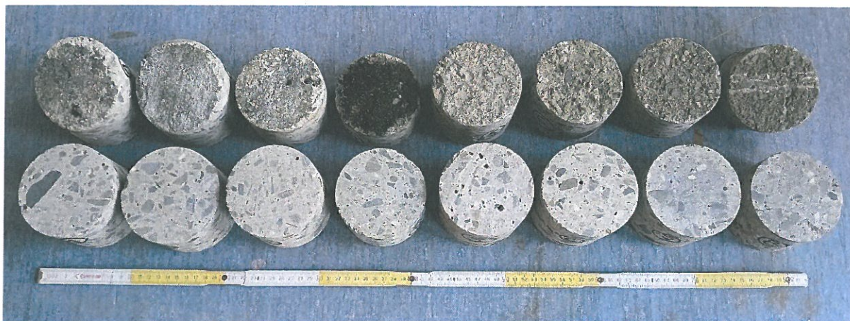
Obr. 5 Betonová zkušební tělesa určená ke stanovení odolnosti betonu proti působení CHRL (na fotografii jsou vidět zkoušené plochy) – horní řada jsou tělesa „A“, spodní řada tělesa „B“
