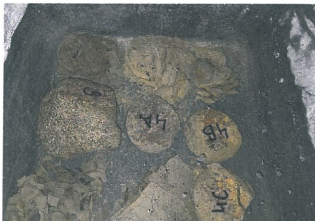
Obr. 9 Detail na vzorky 1 až 4, tzn. vzorky odebrané ze zdi spadiště J23V a J24V (na fotografii nahoře, vzorky se zcela rozpadly) a vzorky odebrané ze zdi skluzu J25V a J26V (na fotografii uprostřed – vzorky bylo možné zvážit, pouze vzorek 4C byl mírně rozpadlý)
