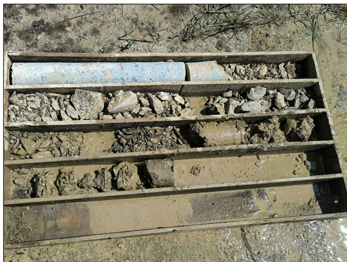
Obr. 25S Výnos jádra ze svislého vrtu J25S do dna skluzu v jádrovnici
