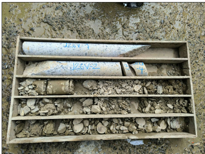
Obr. 26V Výnos jádra z téměř vodorovného vrtu J26V ( -10^\circ od vodor.) do levobřežní zdi skluzu v jádrovnici
