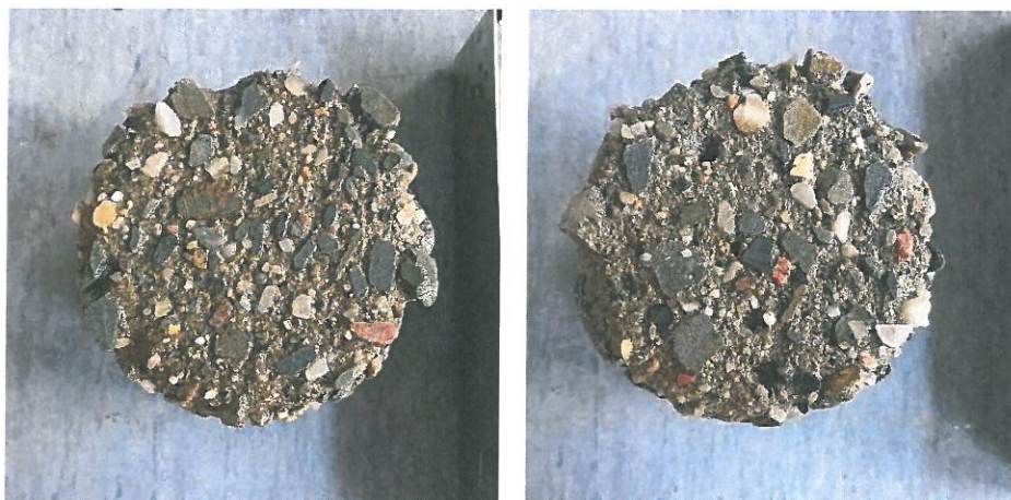
Obr. 17 Zkušební tělesa J25V-1-B (vlevo) a J23S-1-B (vpravo) po 100 zatěžovacích cyklech – poškození zkoušené plochy není nijak výrazné
