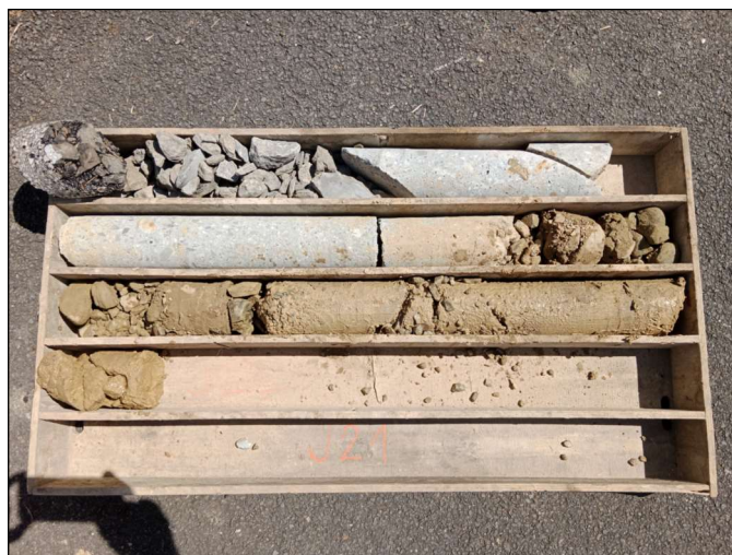
Obr. J21 Výnos jádra z šikmého vrtu J21 (30° od svislé) do okraje vozovky koruny hráze, vlnolamu a jeho založení
