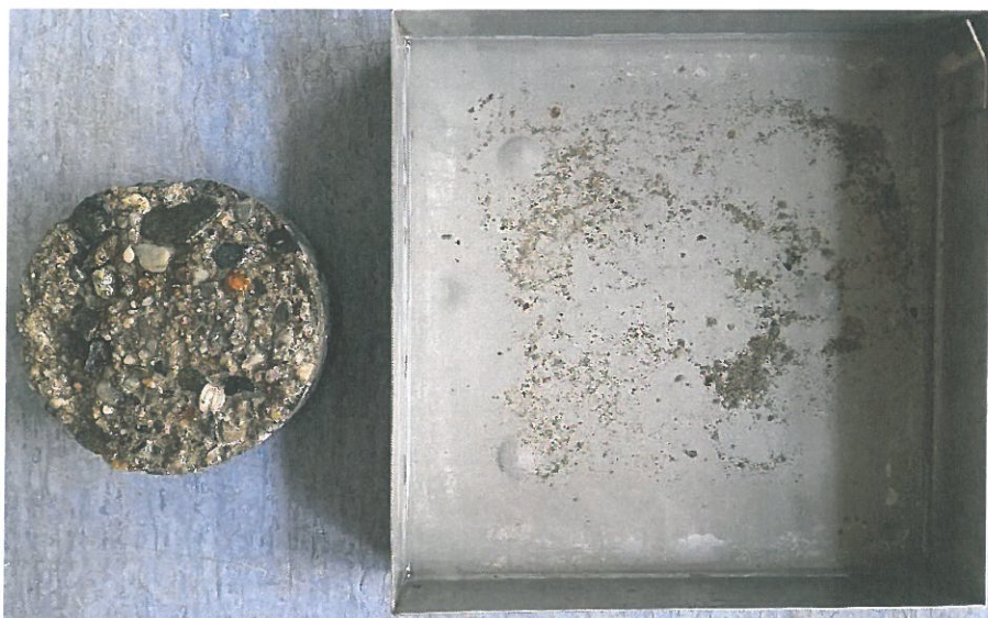
Obr. 15 Zkušební těleso J26V-1-A po 100 zatěžovacích cyklech včetně odpadlých částic v misce – povrch tělesa lze hodnotit jako mírně porušený
