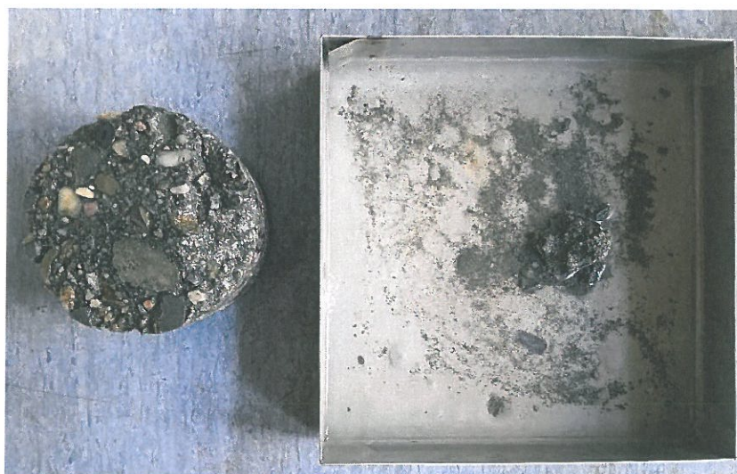
Obr. 18 Zkušební těleso J26S-1-B po 100 zatěžovacích cyklech včetně odpadlých částic v misce – většina hmotnosti odpadu je tvořena lokálně odpadlým kouskem u hrany zatěžované plochy, jinak dokázal beton odolávat působení CHRL výborně
