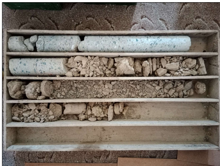
Obr. 26S Výnos jádra ze svislého vrtu J26S do dna skluzu v jádrovnici
