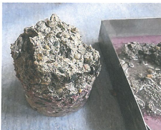
Obr. 13 Zkušební těleso J23V-1-A po 50 zatěžovacích cyklech – povrch tělesa lze hodnotit jako z velké míry rozpadlý
