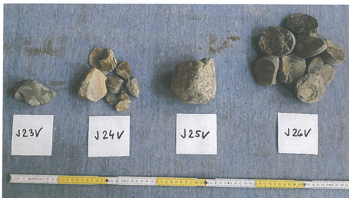
Obr. 1 Vzorky hornin odebrané z vodorovných jádrových vývrtů do zdi spadiště a skluzu
