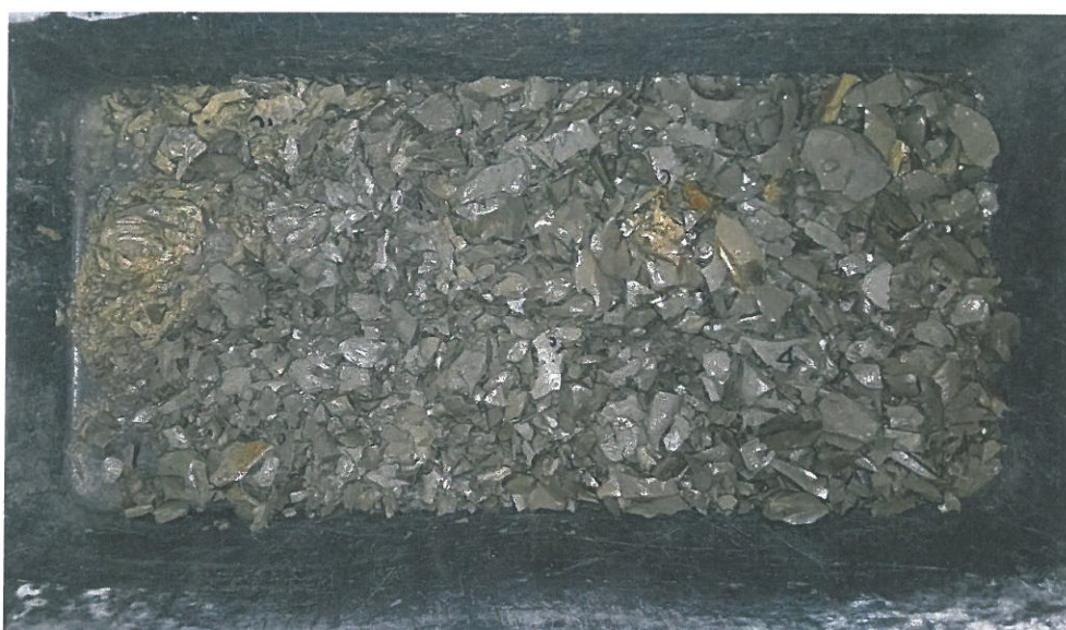
Obr. 12 Pohled do nádoby se vzorky po vyjmutí soudržných vzorků a vylití vody – z většiny vzorků zůstala drť
