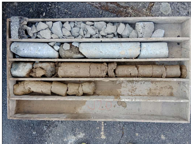
Obr. J20 Výnos jádra z šikmého vrtu J20 (30° od svislé) do okraje vozovky koruny hráze, vlnolamu a jeho založení
