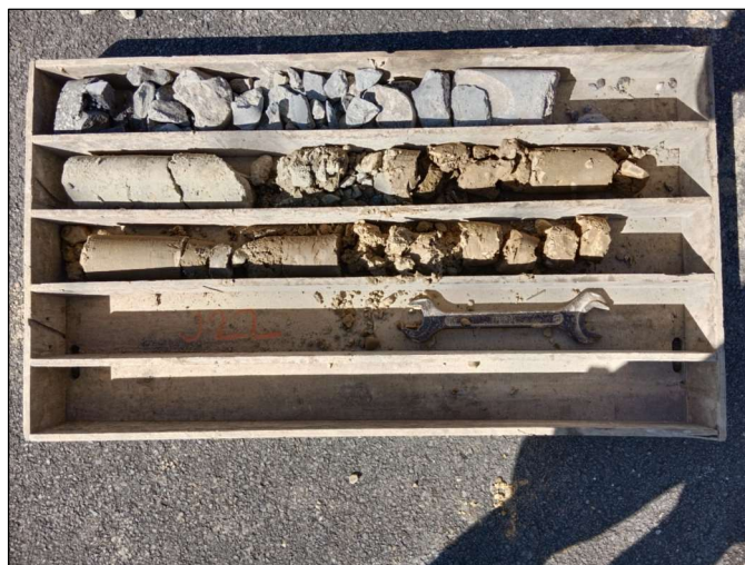
Obr. J22 Výnos jádra z šikmého vrtu J22 ( 30^\circ od svislé) do okraje vozovky koruny hráze, vlnolamu a jeho založení
