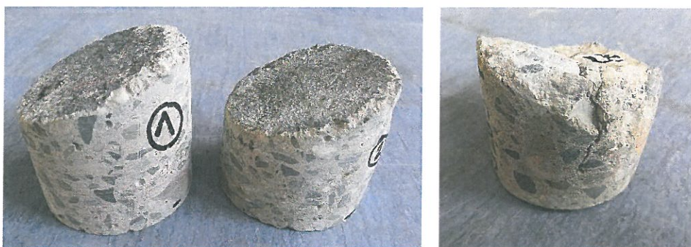
Obr. 6 Vlevo dvě zkušební tělesa s eliptickou zkoušenou plochou, vpravo těleso s trhlinou
