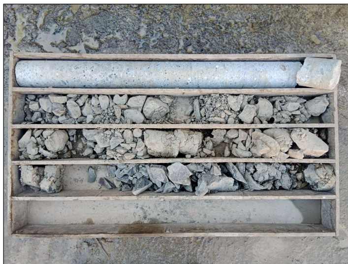
Obr. 23S Výnos jádra ze svislého vrtu J23S do dna spadiště v jádrovnici
