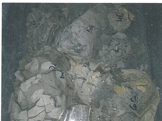
Obr. 10 Detail na vzorky 5 a 6, tzn. vzorky odebrané ze dna spadiště J23S a J24S (na fotografii nahoře vzorky 5, dole vzorky 6 – v podstatě všechny vzorky se rozpadly, podařila se zvážit jedna menší část vzorku 6A)
