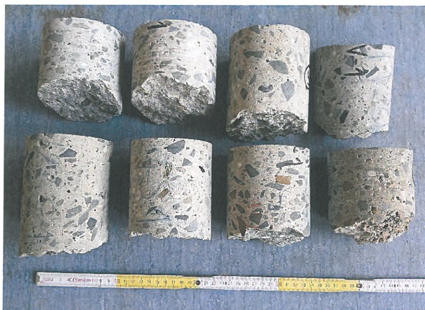
Obr. 4 Betonová zkušební tělesa určená ke stanovení nasákavosti a objemové hmotnosti hydrostatickou metodou (jedná se o koncové části jádrových vývrtů)
